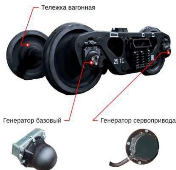
Рис. 4. Схема установки генераторов обоих типов на тележке грузового вагона
