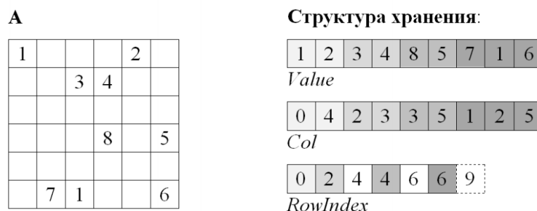
Рис. 1. Пример преобразования матрицы A из обычного в упакованный формат CSR
