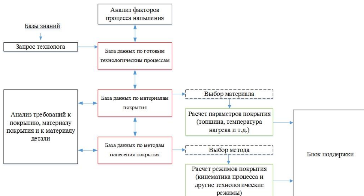
Рис. 2. Схема организации взаимодействия между базами знаний и базами данных, и расчетным программным обеспечением при проектировании покрытий
